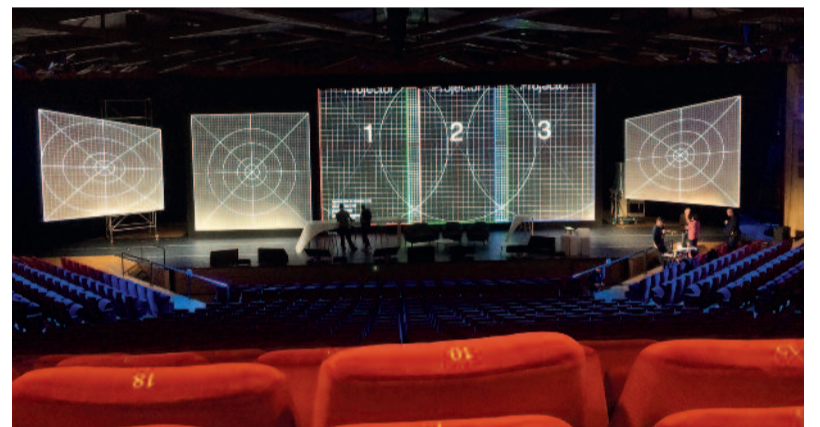
Vidéo projection, divers formats de toiles, projecteurs 14k et 20K avec soft edge.
